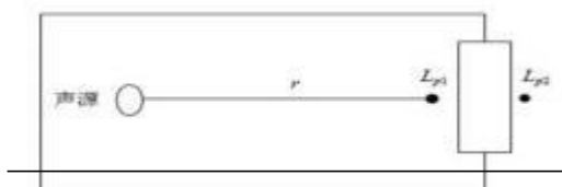
图4-1 室内声源等效为室外声源图例
