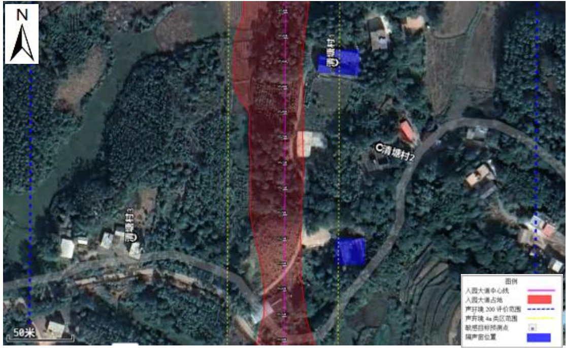
图 VII-10 隔声窗措施示意图 (清塘村 K2+640、K2+780)
